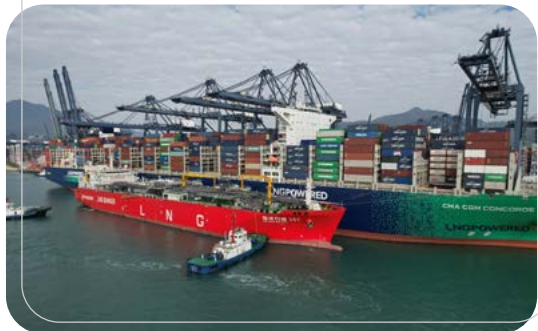
在深圳港盐田港区，全球最大 LNG 运输加注船“海油石油 301”成功为全球最大的双燃料动力集装箱船“达飞协和号”加注 6000 立方米 LNG 燃料，标志着我国华南地区首船国际航行船舶保税 LNG 加注作业顺利完成。
